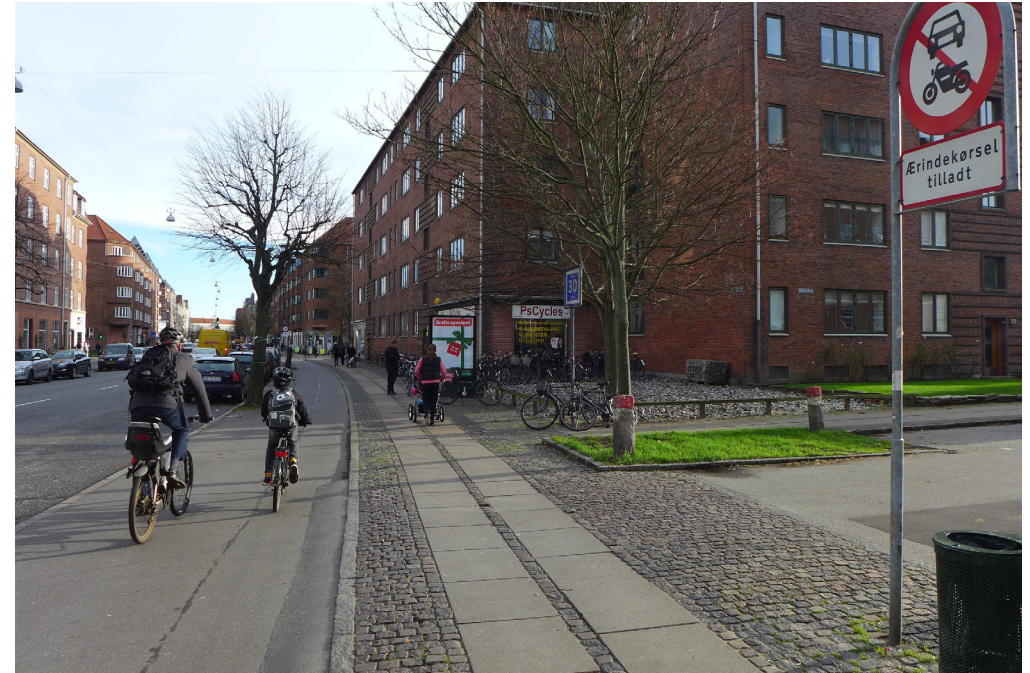
inspirerend voorbeeld waarbij, op een kruising van twee autowegen, het voetpad en het fietspad ononderbroken doorlopen
